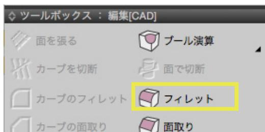
(2) ツールボックス「編集 [CAD]」から「フィレット」を選択します。
