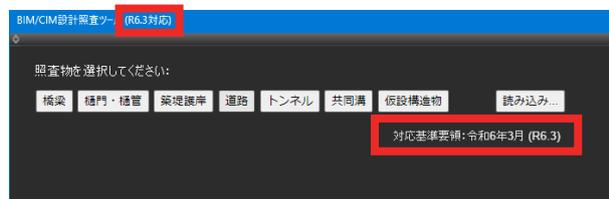
(2) 「橋梁」、「橋門・橋管」、「築堤護岸」、「道路」、「トンネル」、「共同溝」、「仮設構造物」から照査物を選択します。
