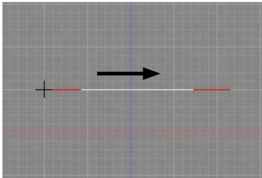
(2) ドラッグしてスロット(直線)の軸を作成します。
