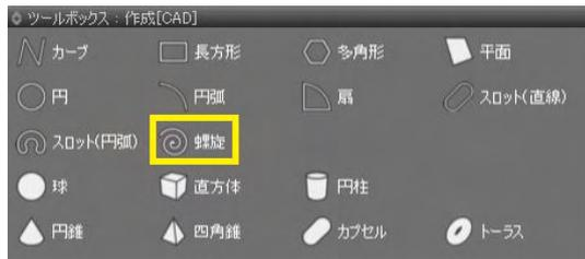
(1) ツールボックス「作成 [CAD]」から「螺旋」を選択します。
