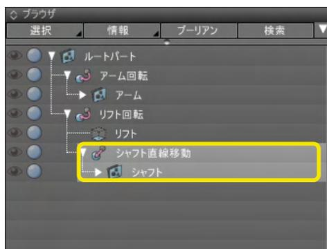
「シャフト直線移動」ジョイントは、シャフト部分を直線移動させます。
