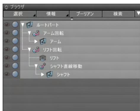
このシーンは、2つの回転ジョイントと1つの直線移動ジョイントが設定されています。
