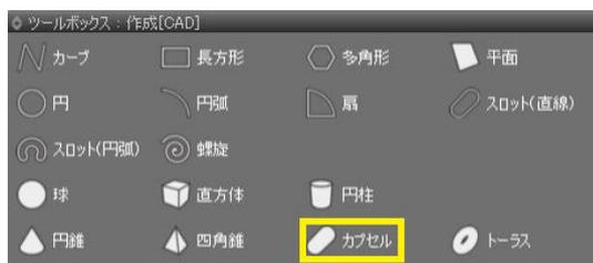
(1) ツールボックス「作成 [CAD]」から「カプセル」を選択します。
