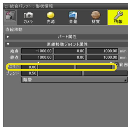
ジョイントの値は「形状情報」ウインドウの「ジョイント属性」にある「スライド」ボックス・スライダを操作して変更します。
