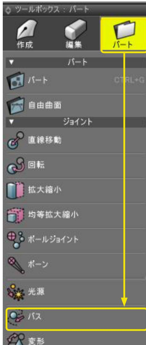
(1) 「ツールボックス」の「パート」から「ジョイント」の「パス」を選択して、「ブラウザ」にパスジョイントを作成します。
