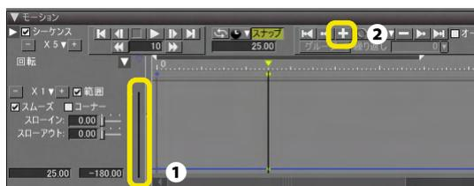
(4) ジョイント値スライダを操作してジョイント値を設定**①**、「+」ボタンをクリックしモーションポイントを作成します**②**。
