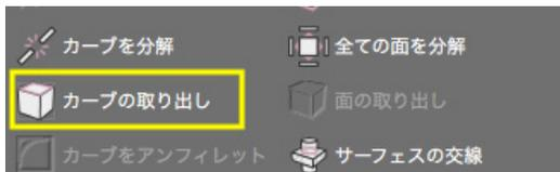
(2) 「CAD」モードでツールボックス「編集 [CAD]」より「カーブの取り出し」をクリックします。
