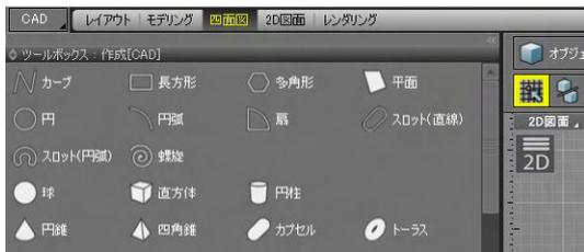
(2) ワークツールボックス、ワークスペースセットが切替わり、NURBS 形状作成・編集のツールボックスが表示されます。
