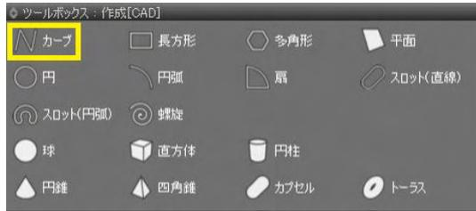
(1) 「CAD」モードでツールボックス「作成 [CAD]」より「カーブ」をクリックします。
