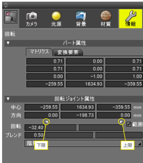
(1) ジョイントを選択し、「形状情報」ウインドウの「ジョイント属性」でリミッタをドラッグして、上限、下限の可動域をそれぞれ設定します。
