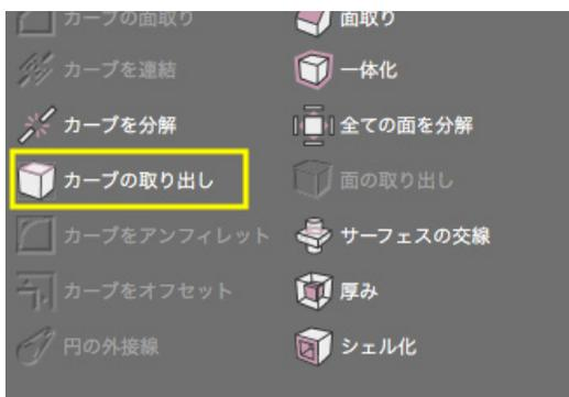
(2) 「CAD」モードでツールボックス「編集 [CAD]」より「カーブの取り出し」をクリックします。
