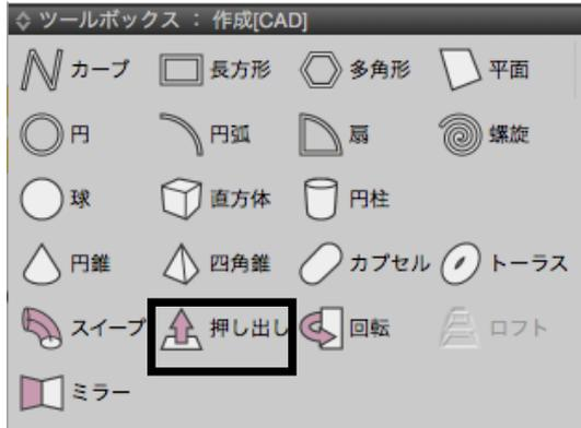
(2) ツールボックス「作成 [CAD]」から「押し出し」を選択します。
