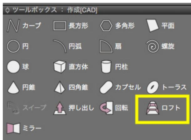
(1) 「ロフト」実行時に「ツールパラメータ」より「曲面を滑らかに」チェックボックスで調整します。
