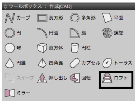
(2) ツールボックス「作成 [CAD]」から「ロフト」を選択します。
