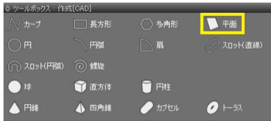
(1) ツールボックス「作成 [CAD]」から「平面」を選択します。
