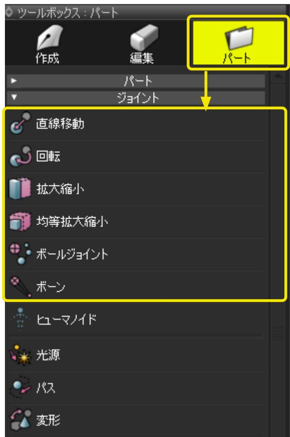
ジョイントの作成は、「ツールボックス」の「パート」の「ジョイント」からツールを選択し、図面上をドラッグして作成します。
