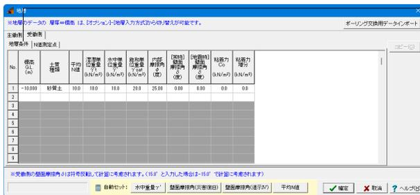
層厚、土質種類、平均N値、土の湿潤単位重量、水中単位重量、飽和単位重量、内部摩擦角、壁面摩擦角、粘着力と粘着力増分が下記の表の値が表示されていることを確認してください。
