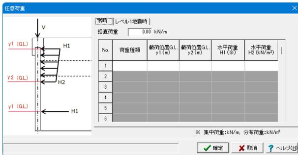
「常時」「レベル1地震時」タブの切り替えでデータを確認・修正してください。
