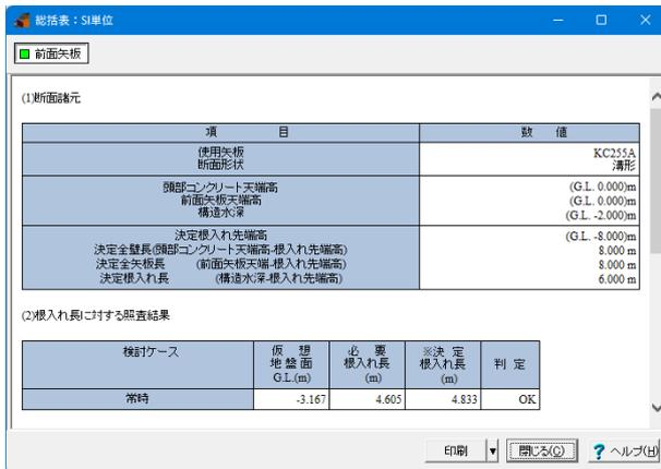
断面諸元、根入れ長に対する照査、断面力、反力、応力度照査結果について一覧表形式で、結果確認、出力ができます。ボタンが赤色の場合は、安全率を満足していないなどの理由により、OUTの旨を提示しています。
