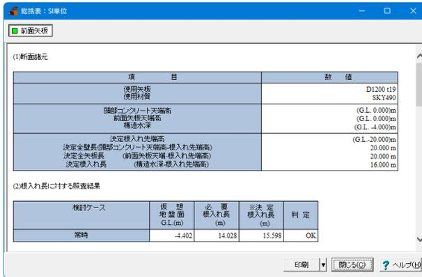
断面諸元、根入れ長に対する照査、断面力、反力、応力度照査結果について一覧表形式で、結果確認、出力ができます。ボタンが赤色の場合は、安全率を満足していないなどの理由により、OUTの旨を提示しています。
