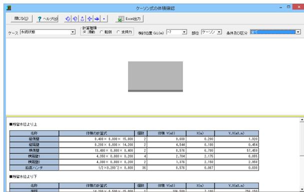
詳細確認では、壁体重量及びそのモーメントを算定する際に行った体積計算がそれぞれどの箇所に当たるのかを3Dにより確認することができます。
