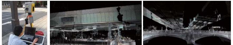
▲3Dレーザスキャナ ▲点群プラグインでUC-win/Roadへ取り込んだモデル (日本橋交差点、日本橋)
