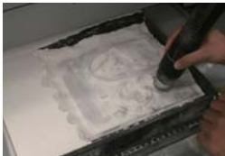
3.石膏を吸引 (バキューム)
