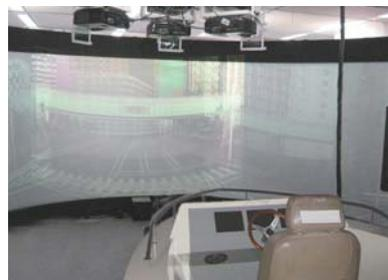
▲3Dステレオ船舶シミュレータ構築例
