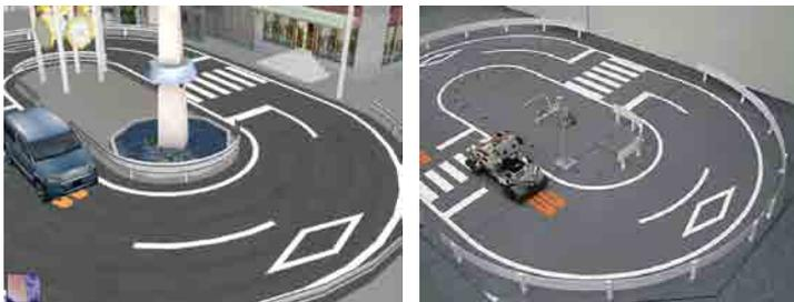
▲모형으로 주행 환경을 작성하여 (좌측 그림) VR공간내에서 시뮬레이션 주행 (우측 그림)
