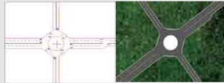
S-Paramics로부터 로터리를 임포트 한 결과입니다. 로터리 속성을 가지고 있는 Node를 UC-win/Road에서 표현합니다. 또한 우측 횡단면의 변화를 표현하고 있습니다.
