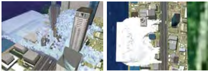
▲津波シミュレーション(粒子法解析結果利用提案モデル)
