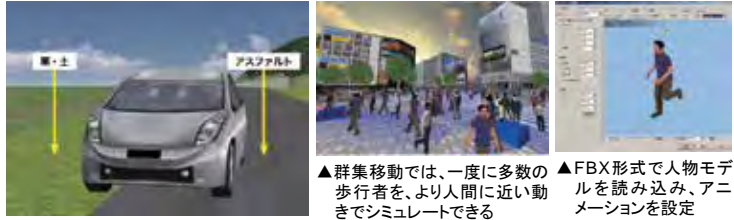
▲左右のタイヤ別の振動が発生できる ▲群集移動では、一度に多数の歩行者を、より人間に近い動きでシミュレートできる ▲FBX形式で人物モデルを読み込み、アニメーションを設定
