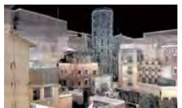
▲3Dレーザースキャンによって投影対象を計測建物の点群データをもとに、建物の3Dモデルを作成
