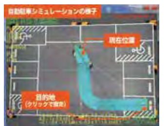
UC-win/Roadのドライビングシミュレーション機能と連携する「RoboCar」。この技術に車両軌跡作図システムを連携させて実車に拡張すると自動駐車も夢ではなさそうです▶
