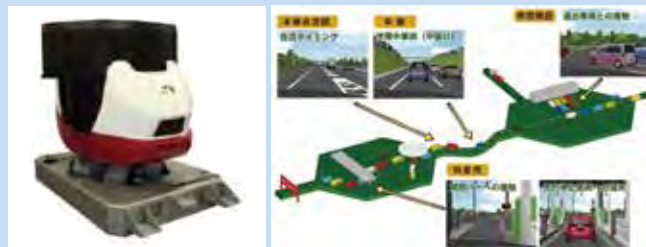
▲ハイウェイドライビングシミュレータ(左) 速道路上での危険を伴う19の危険事象を再現(右)
