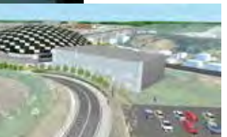
3Dスキャナで計測した周辺環境の点群データをVR上に読み込み検討
