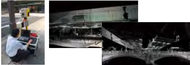
▲3Dレーザスキャナ ▲点群プラグインでUC-win/Roadへ取り込んだモデル (日本橋交差点、日本橋)
