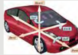
▲サージ、スウェイ、ヒーブ、ロール、ピッチ、ヨーの6自由度運動が可能
