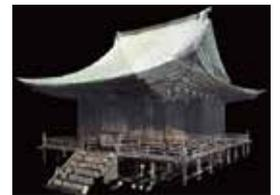
計測された点群データをもとに建物の3Dモデルを作成
