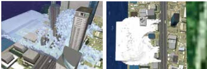
▲津波シミュレーション（粒子法解析結果利用提案モデル）
