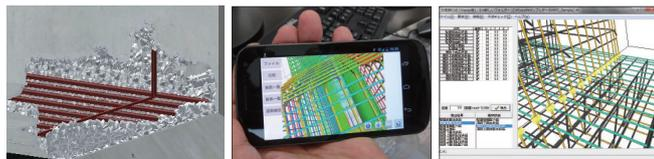
现有结构的受损区域和修复 3D配筋CAD for Saa 状态的3D表示
