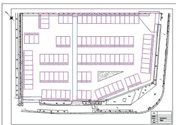
▲在新设计图上制作外围/通道后一次性配置停车位
