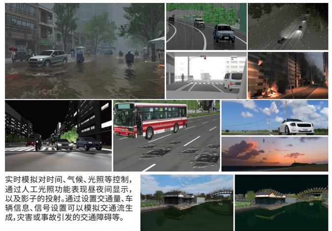
实时模拟对时间、气候、光照等控制, 通过人工光照功能表现昼夜间显示, 以及影子的投射。通过设置交通量、车辆信息、信号设置可以模拟交通流生成, 灾害或事故引发的交通障碍等。
