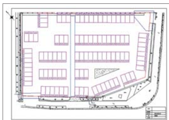
▲在新設計圖上制作外周、道路後一次性配置停車位
