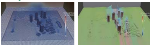
▲ 新宿副都心中心的網格和風速分布圖(輪廓/方向)
