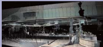
通過3D激光掃描支援點雲計測和建模
