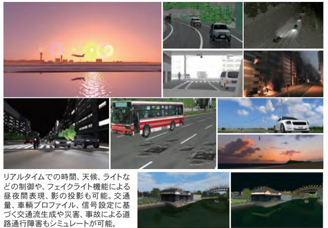
リアルタイムでの時間、天候、ライトなどの制御や、フェイクライト機能による昼夜間表現、影の投影も可能。交通量、車輪プロファイル、信号設定に基づく交通流生成や災害、事故による道路通行障害もシミュレートが可能。
