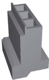
▲図1 橋軸方向 段差フーチング
