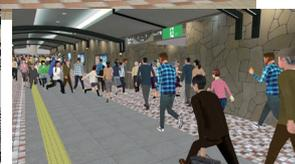
JR大阪駅南側の地上・地下約300m四方をモデル化したデータ。ビルや地下通路を精密に再現し、車両や人々の行動をシミュレートすることで、車両信号制御や地下街での群集行動解析、災害時の避難誘導やサイネージによる人流誘導の効果検証など、ICTによる未来社会の最適化を探索する研究への利用が想定されています。
