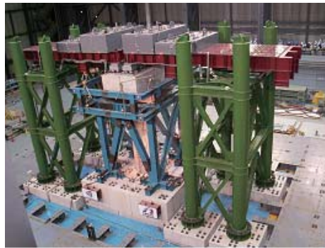
▲実物大の構造物の振動実験が行える巨大振動台「E-ディフェンス」(左)とコンピューターによる振動解析用モデル(右)
