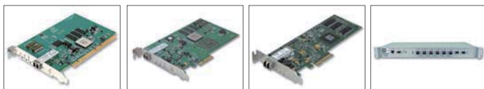
■ 図1 リフレクティブメモリ （左からPCI用、PCI Express用、PCI Express LowProfile用、8ポートHub）
