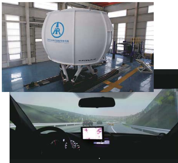
■超大型 8 軸ドライブシミュレータ（中国交通部）
