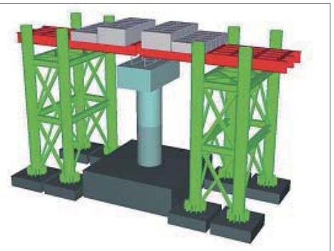
▲実物大の構造物の振動実験が行える巨大振動台「E-ディフェンス」(左)とコンピューターによる振動解析用モデル(右)
