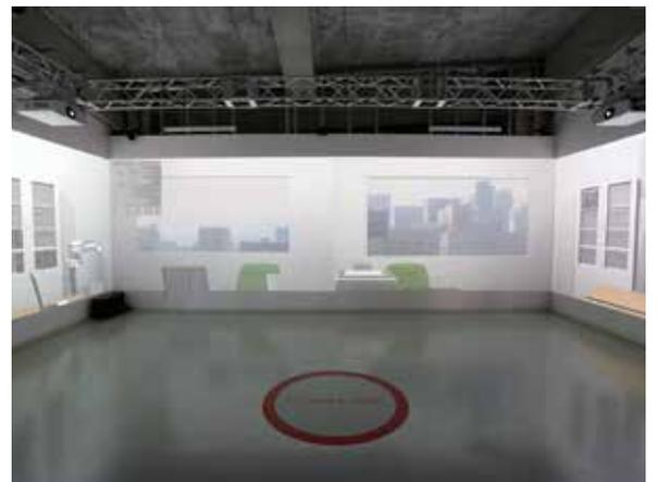
屋上実験室では、地震時の揺れ・映像・音響が体験できるシステムを設置。通常は固定されている免震構造の建物を振動台としてアクチュエータで加振する
