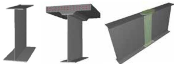
▲非合成I桁(左)と合成I桁(中央)、連結板(右)
