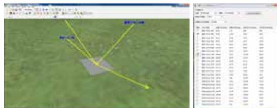
■太陽パネル反射光シミュレーション
