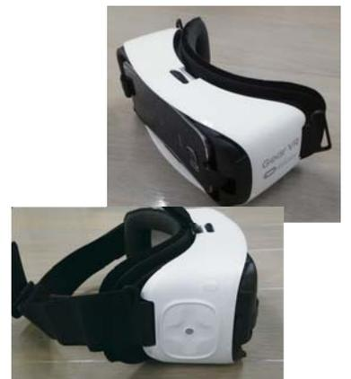
写真3 ゴーグル側からスマホを操作できるHMDの例 SAMSUNG Gear VR
