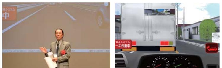
ADAS (自動車の先進運転支援システム) をシステム未導入のユーザが体験するためのDS用VRデータ。衝突防止「プリクラッシュセーフティシステム」、先行車自動追尾「アダプティブ・クルーズ・コントロール」、走行車線逸脱防止「レーン・ディパーチャー・ワーニング」の各機能を専用機能、シナリオ機能を駆使して再現している。
