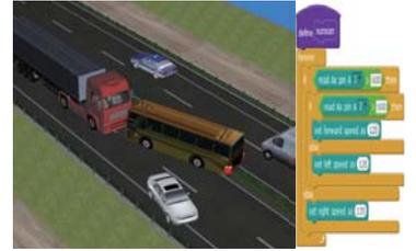
UC-win/Roadのために開発されたグラフィカルインターフェースを用いることで、ユーザはフローチャートのような図を描くだけでプログラミングの意図を述べる事が出来ます。フローチャートが作成された3Dモデルの挙動を制御するスクリプトの機能を果たします。このようにして、Delphi言語に馴染みのない人や、プログラミングの経験がない人も、UC-win/Road用の複雑な輸送アルゴリズムを開発したり、関連する問題を解いたりすることが出来ます。このプラグインによって、Roadユーザはプログラミング経験が豊富な人からそうではない人にまで増えるでしょう。
