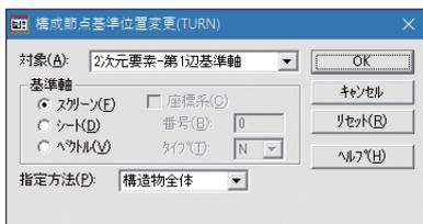
対象「2次元要素 - 第1辺基準軸」、基準軸「スクリーン」、指定方法「構造物全体」を指定して「OK」をクリックします。画面上から下記の2節点を指定して基準軸を決定します。
