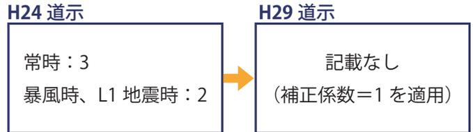
図4 基礎前面の水平地盤反力度の上限値の補正係数
