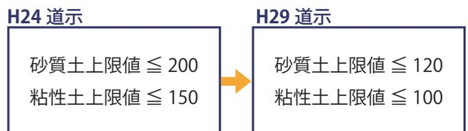
図6 基礎側面及び周面の地盤反力度の上限値
