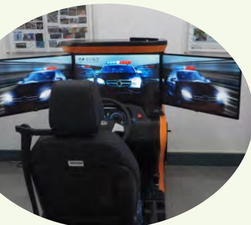
台湾・桃園市にある中央警察大学は、1936年に創立された台湾警察のエリート養成機関です。校舎内には訓練用にフォーラムエイトのドライビングシミュレーター3台が設置されています。UC-win/Roadで作られた訓練コースには、「突然ドアを開ける駐車車両」「車線をこころろ変えながら走るバイク」などが再現され、警察官はこうした台湾特有の危険な状況の中で安全に運転する技術を磨いています。
