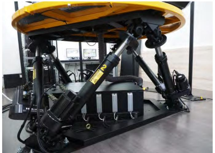
6自由度のモーションプレートは、車の動的特性を忠実に再現する
