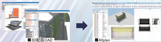
UC-1設計シリーズから3D配筋CADへシームレスにデータ連携。3D配筋CADで躯体/鉄筋の編集や干渉チェック、さらにAllplanへ発展させて図面作成や高度な編集が可能
