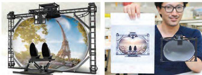
田村さんがShade3Dで作成した半球型ドームスクリーン「Sphere 5.2」のイメージ(左)。作成したデータから直接3Dプリンタで模型を出力した(右)
