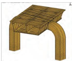
▲コンクリートが充てられた門形鋼製橋脚に支えられた波形鋼板ウェブ橋のような複雑な構造も手軽に解析できる
