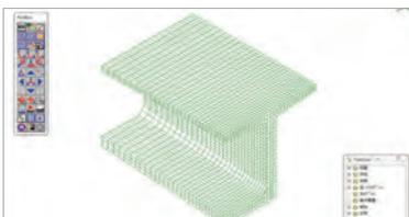
▲両端にメッシュ分割された断面図を置き、その間を「面と面の結合によるメッシュ分割」で3次元メッシュに分割する
