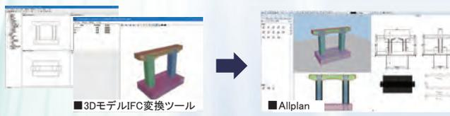
UC-1設計シリーズの3D配筋データを3DモデルIFC変換ツールからCIMモデルとして出力、Allplanで躯体/鉄筋の修正、干渉チェック、図面作成が可能
