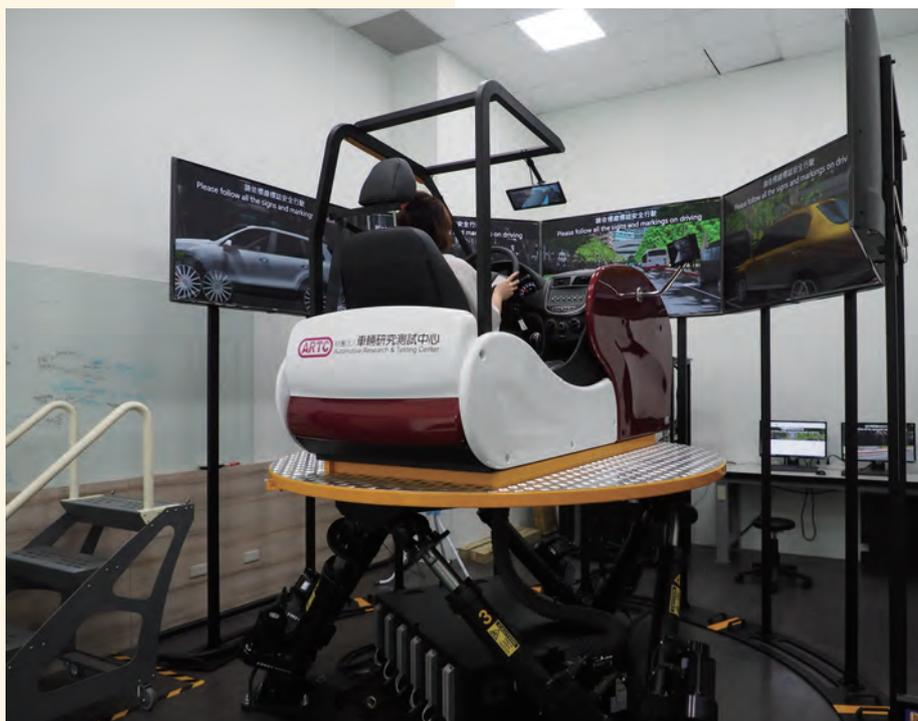
上下左右前後の変位と回転を再現する6自由度のモーションプレート付きドライビングシミュレーター
