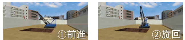
図10 4Dシミュレーション実行中の様子
