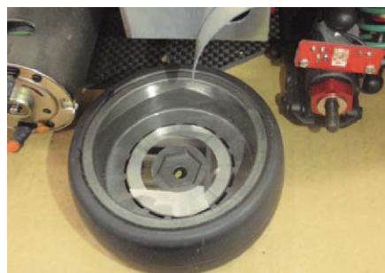
■図4 RoboCar車輪の(光)回転エンコーダ
