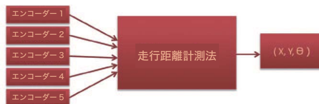
■図5 走行距離計測法の原理を用いた現在の位置情報 (X, Y, Θ) の計測
