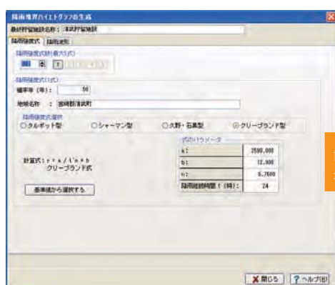
■図5 降雨強度式による計画降雨波形の生成
