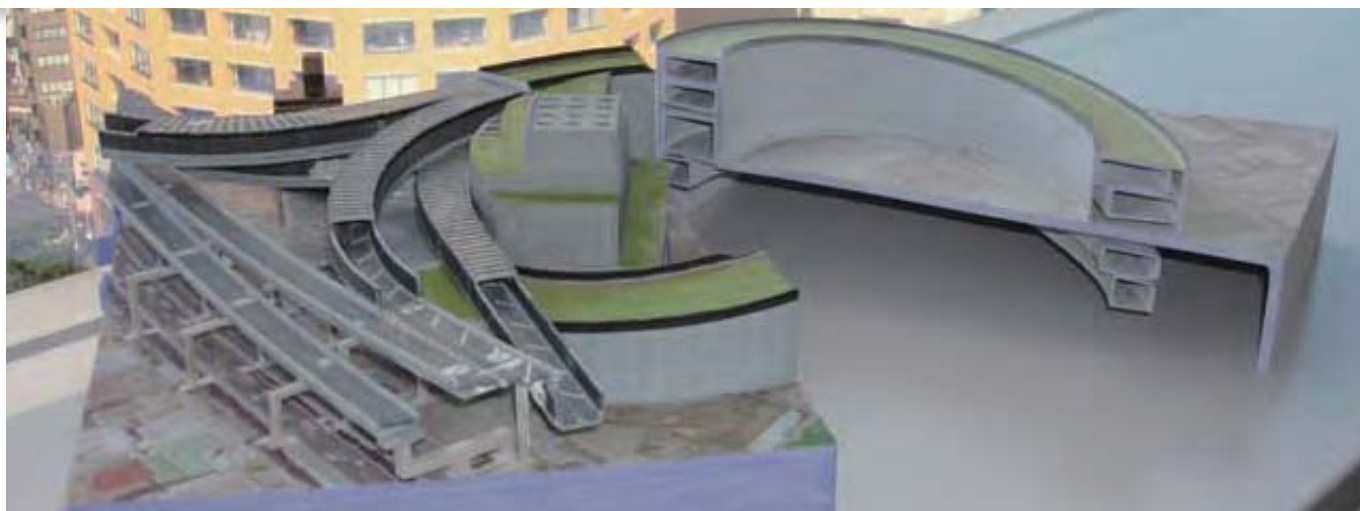
■図2 UC-win/Road で作成された VR データを 3ds Max に読み込んで、3D プリントした模型
