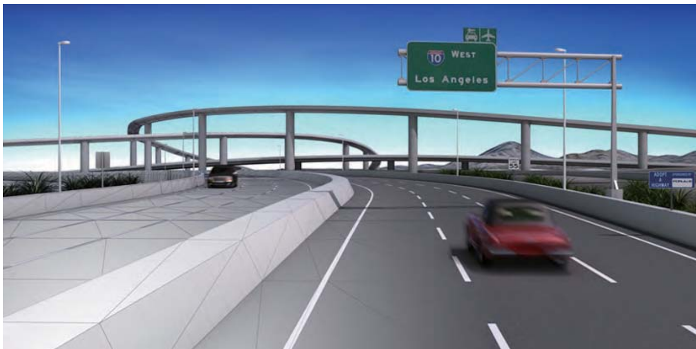
■図1 UC-win/Road で作成された VR データを 3ds Max に読み込み、モーションブラーなどの特殊効果を加えてレンダリングを行った
