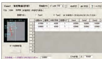
▲鉄筋の入力例。鉄筋の層ごとに入力できるので効率的だ
