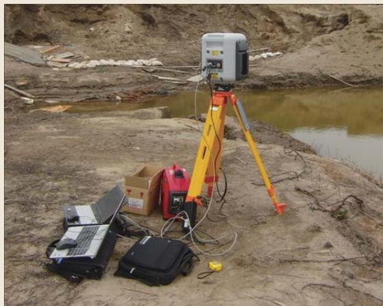
■図1 点群データ計測システム
