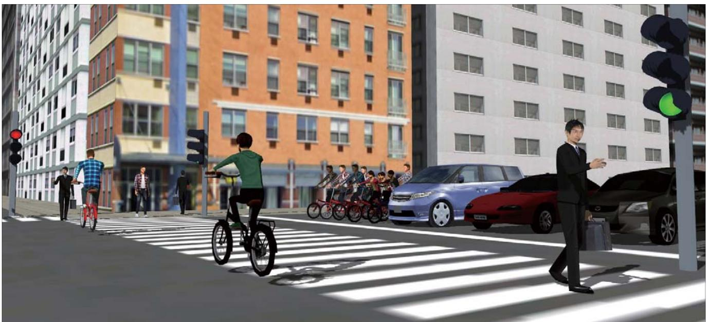
■図1 VISSIM の解析結果を読み込んだ交差点のシミュレーション
