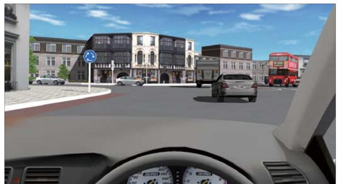
■図7 運転時の周辺車両をマイクロシミュレーションプレーヤーで制御
