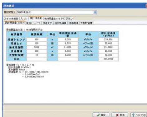
■図 5 浸透施設—設計浸透量確認画面
