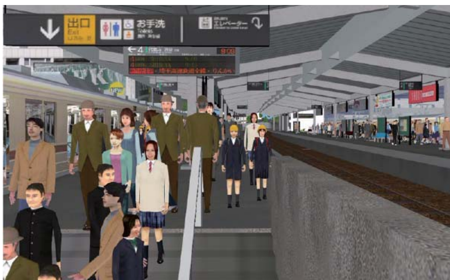
中目黒駅旅客流動シミュレーション。EXODUSとUC-win/Roadの連携により、群衆の動きを可視化。
