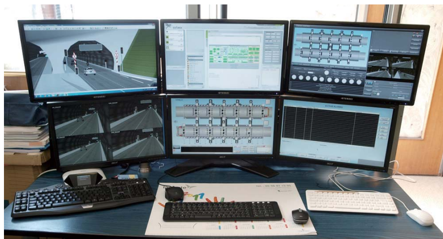
「G'VAL Training System」のデモンストレーションに使う 6 面スクリーン。3 台のパソコンに接続されている
