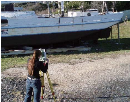
■図 1 サーベイ用機器を使って、船の形状を計測するボランティア
