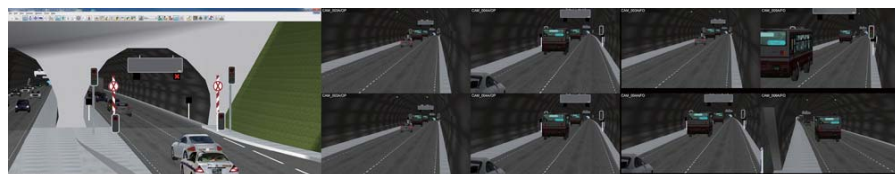
UC-win/Road を通じて表示されたトンネル各部分の監視カメラ映像
