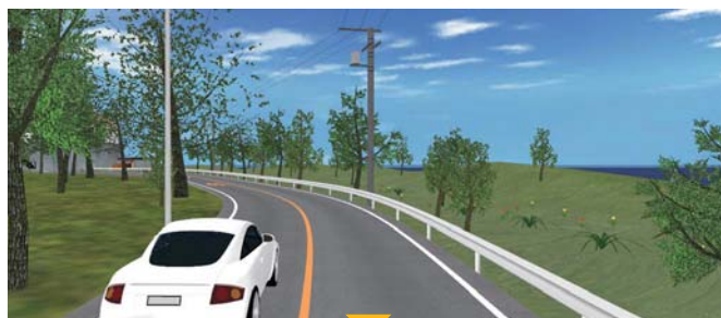
■図5 POV-Ray にて建物、車両のマテリアルを編集し、レンダリング
