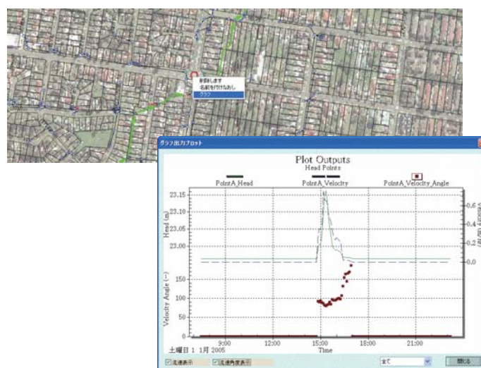
■図9 任意地点における流速及び流速ベクトルの時刻歴出力
