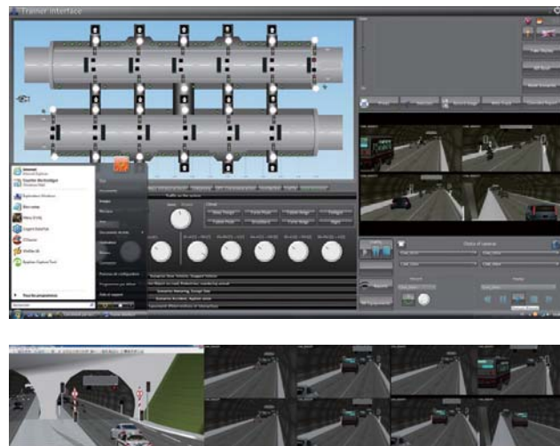
■ BMIA社「G'VAL」のシステム構成図（左）、教習用の画面（右上）、UC-win/Roadにより表示されたトンネル各部分の監視カメラ映像（右下）
