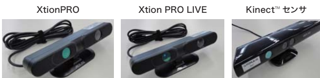
■図1 赤外線深度センサ (Xtion PRO, Xtion PRO LIVE, Kinect™)
