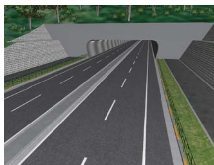
▲道路の3次元線形が出来上がるとトンネルや法面のテクスチャーを設定する
