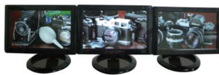
◀図2 RockVision 3D : 裸眼3D対応7インチUSBディスプレイ
