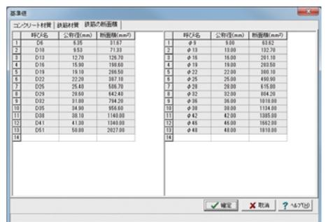
■図 3 基準値-鉄筋の断面積画面
