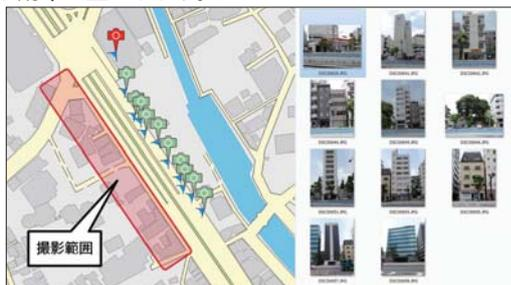
■図1 GPS 搭載カメラなら地図上や写真データから撮影位置を容易に特定できる
