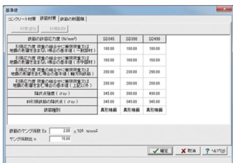
■図 4 基準値-鉄筋材質画面
