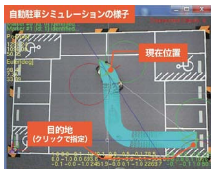
▲ UC-win/Road のドライビングシミュレーション機能と連携する「RoboCar」。この技術に車両軌跡作図システムを連携させて実車に拡張すると自動駐車も夢ではなさそうだ
