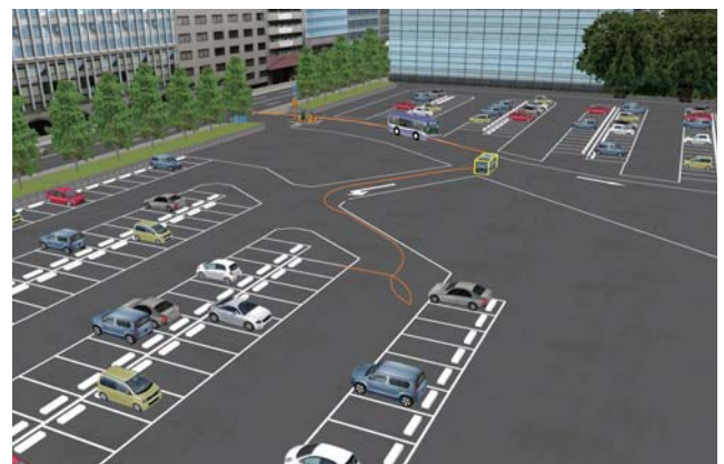
▲UC-win/Roadと駐車場作図システム、車両軌跡作図システムの連携による駐車シミュレーション
