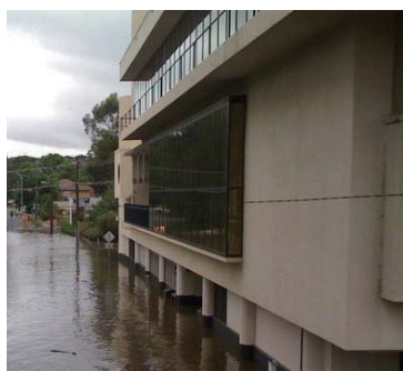
■図2 柱状建築基礎での浸水の例(：Queenbeyan, 2010年12月)
