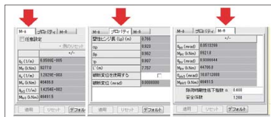
■図 4 M-φからM-θへの変換
