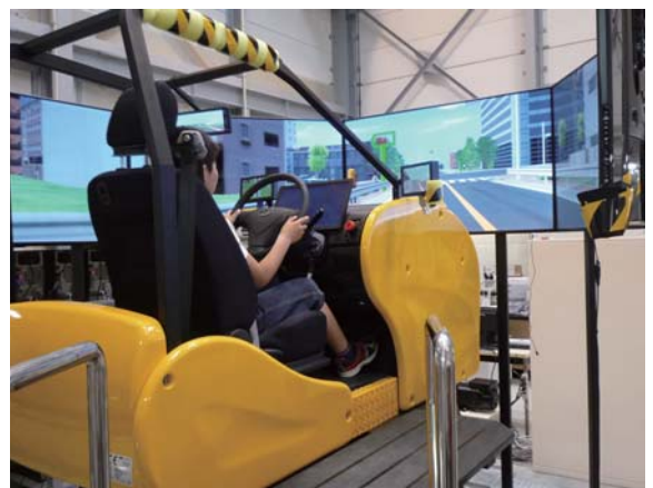
■九州大学に納入した高度研究用ドライビングシュミレータ
