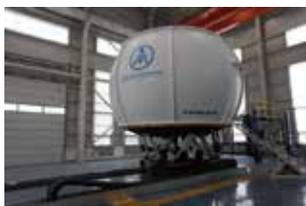
8自由度車両運動モデル実車運転模擬装置です。UC-win/Roadクラスタ構成による360度投影、音響システム、振動装置により実運転に近い環境を提供。交通流シミュレータ、車両運動モデル、視線追跡などの計測装置も連携しています。
