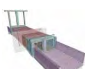
▲柔構造樋門の設計 本体縦方向、門柱、胸壁、翼壁、 しゃ水工をサポート
