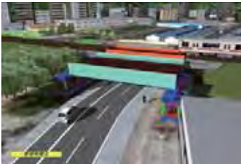
▲「橋梁付替えにおける施工工程および施工VRシミュレーション計画」
