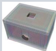
▲鉄筋の開口部カット
