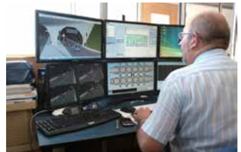
▲UC-win/Roadでトンネル事故時の対応を訓練するBMIA社のトンネルシミュレーター
