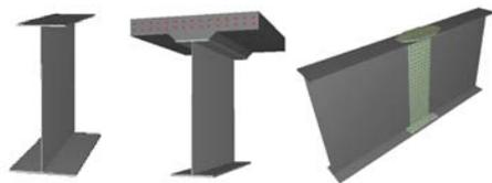
▲左：非合成I桁、中央：合成I桁、右：連結板
