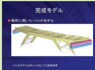
▲鋼橋耐震補強設計事例
