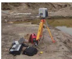
▲点群データ計測システム
