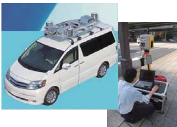
▲MMS(左)と据え置き型の3Dレーザースキャナ(右)
