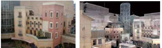
▲3Dレーザスキャンによって投影対象を計測建物の点群データをもとに、建物の3Dモデルを作成
