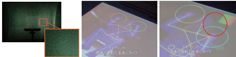
▲赤外線レーザーのパターン ▲直進 ▲右折: 右に切るほど、右方に赤いバーが伸びる
