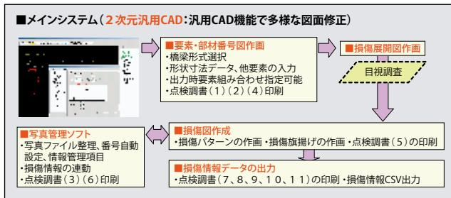
「橋梁点検支援システム」の全機能を継承し、「道路橋に関する基礎データ収集要領(案)(平成19年5月)国土交通省・国土技術政策総合研究所」に準じた橋梁諸元、調査結果シートを効率よく作成する事が出来る橋梁点検支援システムです。
