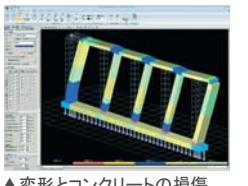
▲変形とコンクリートの損傷
