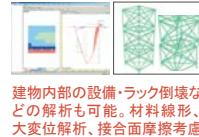
建物内部の設備・ラック倒壊などの解析も可能。材料線形、大変位解析、接合面摩擦考慮などにより解析を行います。
