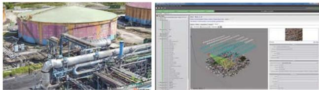
▲ContextCapture：リアリディメッシュ(写真テキストチャ付3Dモデル)により、現実のコンテキストを正確に反映(左)/写真から空中三角測量を自動実行可能(右)
