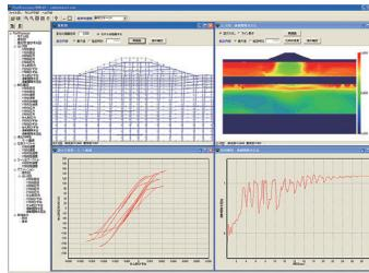
▼過剰間隙水圧比(2次元液状化解析)
