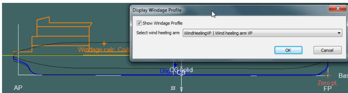
選択された可変風速度ヒーリングアームに定義された高さゾーンを表示している風プロファイル
