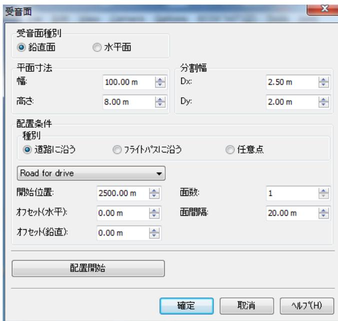
[受音面種別]: 鉛直面または水平面のいずれかを設定します。
