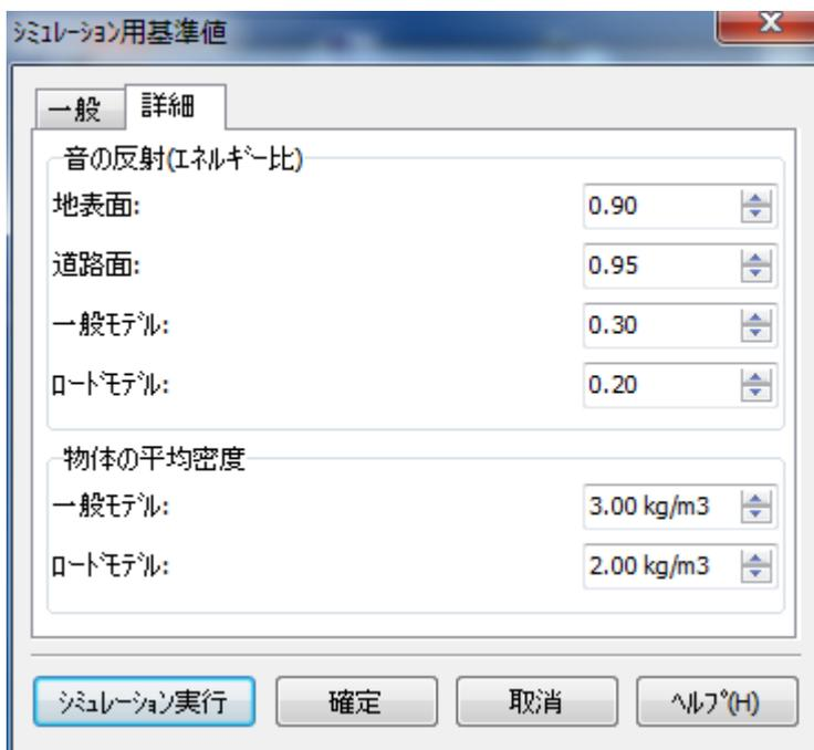
[音の反射(エネルギー比)]: それぞれの面での音の反射率を設定します。(入力範囲: 0.01 - 1.00)
