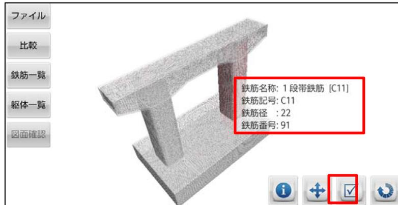
(3)  こちらの状態の場合、鉄筋選択不可で、鉄筋情報は表示されないことを確認します。
