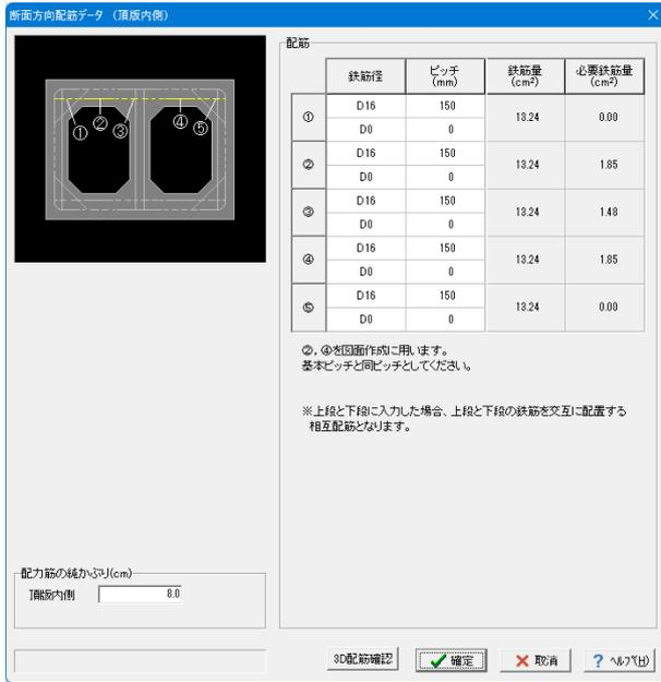
設計断面ごとに鉄筋径とピッチまたは本数を入力します。
