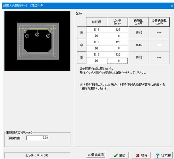
設計断面ごとに鉄筋径とピッチまたは本数を入力します。
