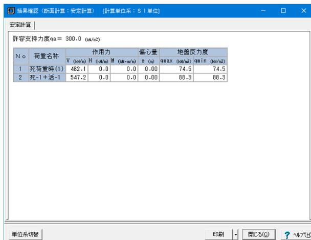
基礎形式=地盤反力度のとき、底版下面中心における作用力集計値と地盤反力度を表示します。杭基礎のとき、杭反力および杭頭結合計算結果を出力します。
