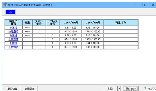
樋門 RC応力度計算結果確認後、閉じるボタンをクリックします。
