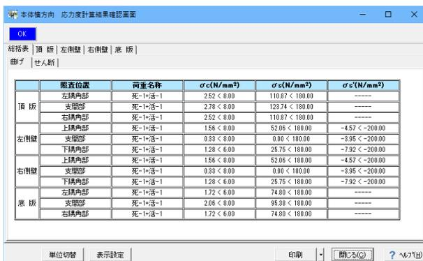
本体横方向応力度計算結果確認画面を確認後、閉じるボタンをクリックします。
