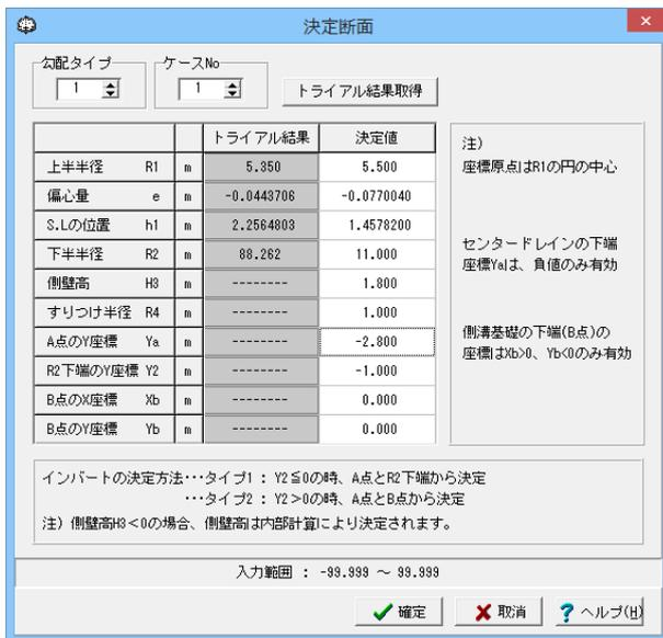
②拡大図に従って断面の上半半径R1、偏心量e、S.Lの位置h1、下半半径R2、側壁高H3、すりつけ半径R4、A点のY座標Ya、R2下端のY座標Y2、B点のX座標Xb、B点のY座標Ybを入力します。
