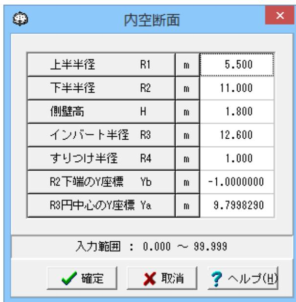
②拡大図に従って断面の上半半径R1、下半半径R2、側壁高H3、インバート半径R3、すりつけ半径R4、R2下端のY座標Yb、R3円中心のY座標Yaを入力します。
