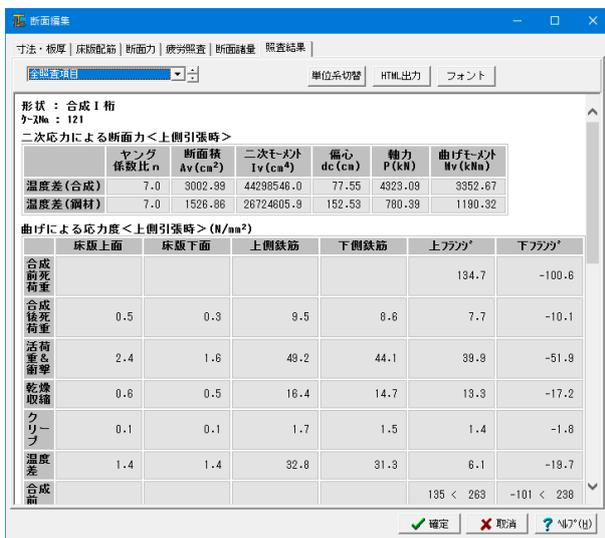
ここでは照査結果の確認ができます。(断面力値の入力がない場合、合成桁以外は計算しません) 確認後、確定ボタンをクリックします。
