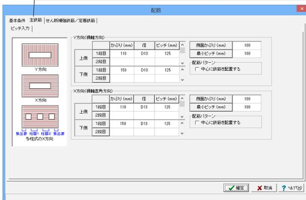
「主鉄筋」タブをクリックします。下図を参考に、入力します。
